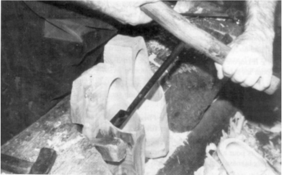
Creusage des sabots du moyen de la “cuillère”.
