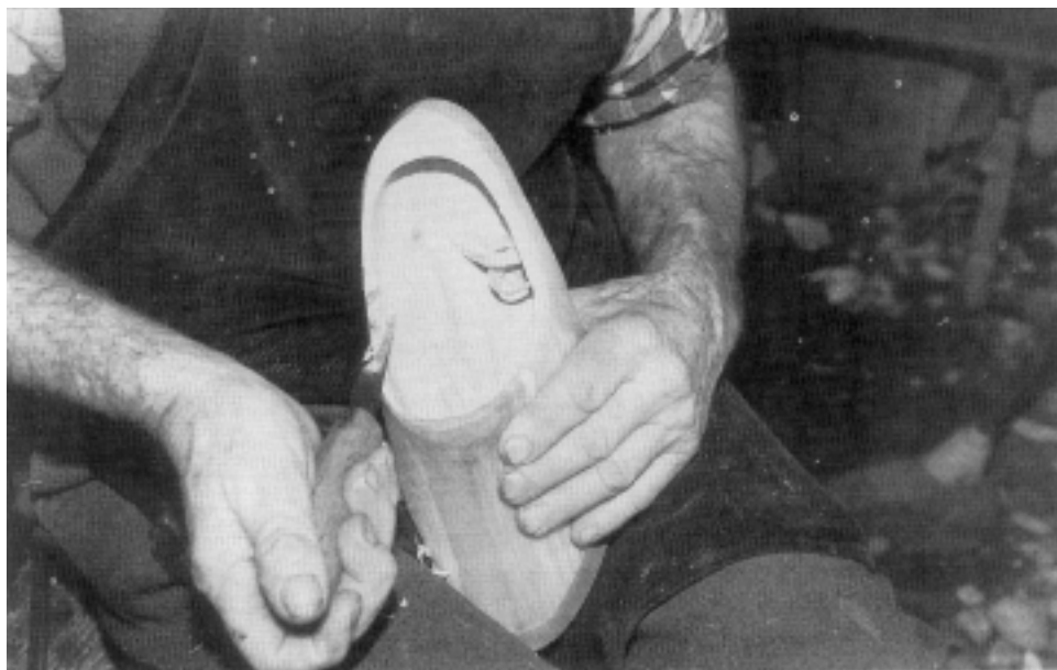
Finissage du sabot avec le couteau.
